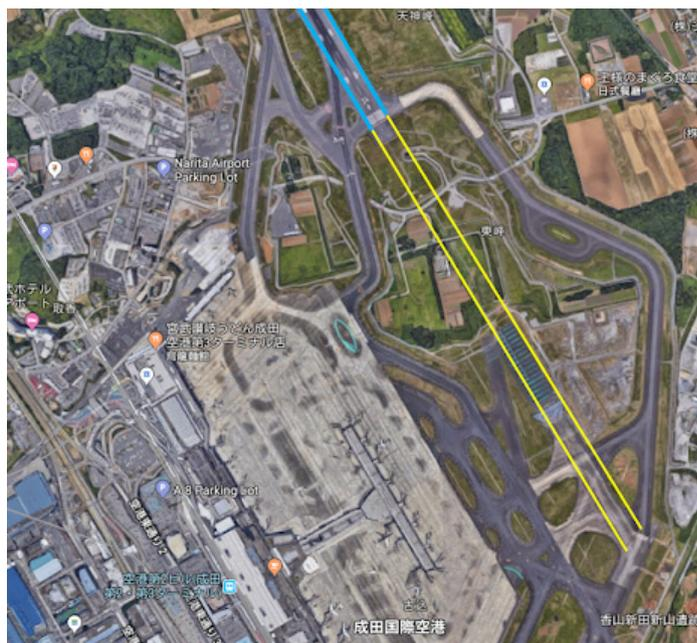
右上圖：成田機場原先預計有兩條 4000 公尺跑道，其中第 2 跑道部分（黃線 + 藍線），因包含東峰神社在內的釘子戶，就位於計畫中跑道的中央地帶，致使原先 4000 公尺的跑道長度，被迫縮短為 2180 公尺，而無法起降 747 等大型客機，因此有了第二跑道延伸計畫，往南走遇到阻礙，後來於 2006 年改向北延伸，在工程順利下，2009 年延伸部分跑道也才完成，現在第 2 跑道為 2500 公尺，圖中藍色線為現行跑道，黃色線則為原計畫中跑道。
